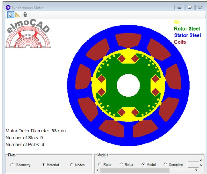
Abb. 196: Synchronous Motor - vier Pole
