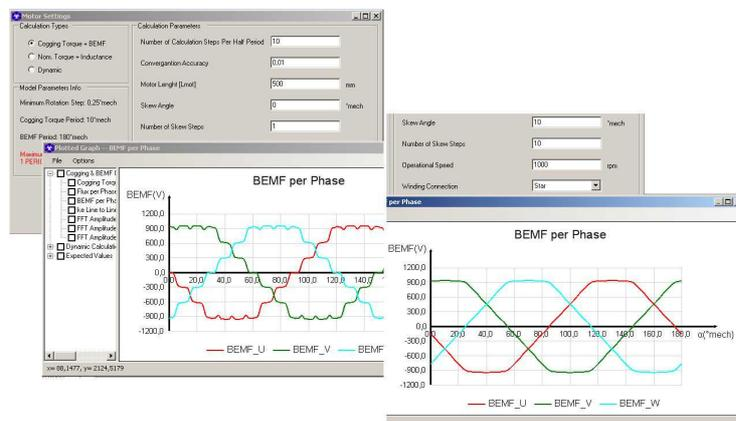
Abb. 84: Beispiel für Beeinflussung der BEMF durch Schrägung
