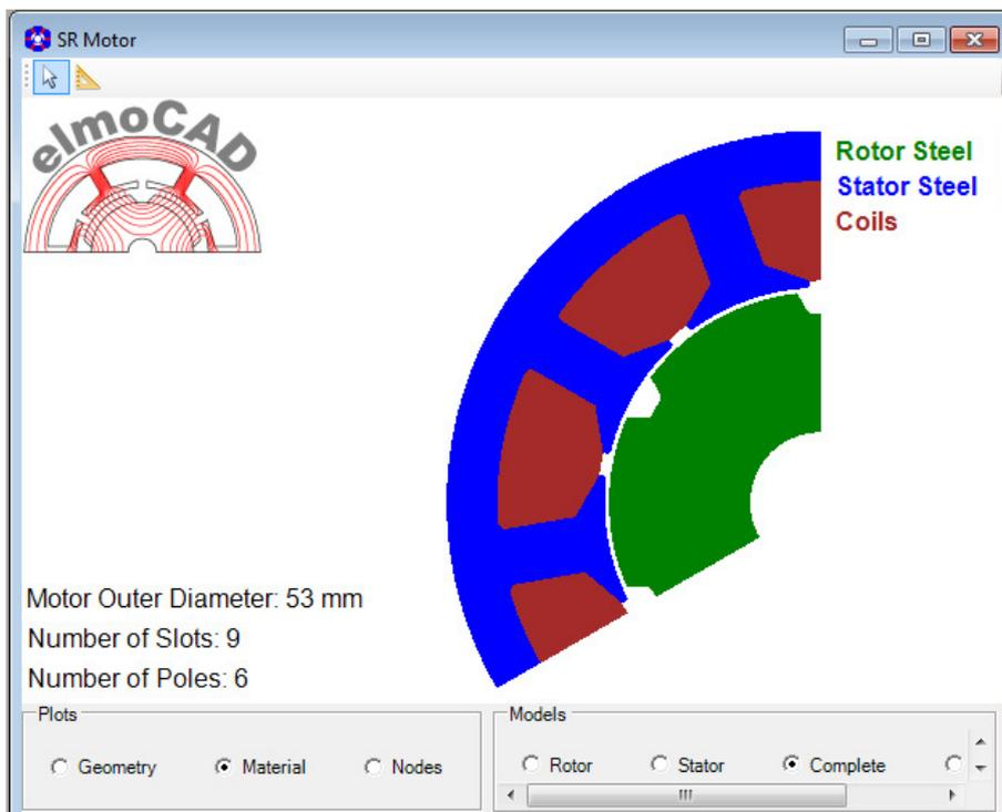
Abb. 210: SR Motor - Beispiel eines Geometriemodells
